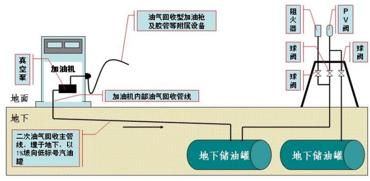
图6 加油油气回收系统基本原理图
