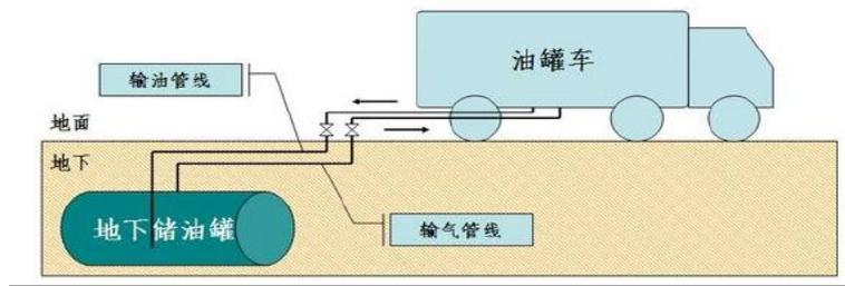
图5 卸油油气回收系统基本原理图
