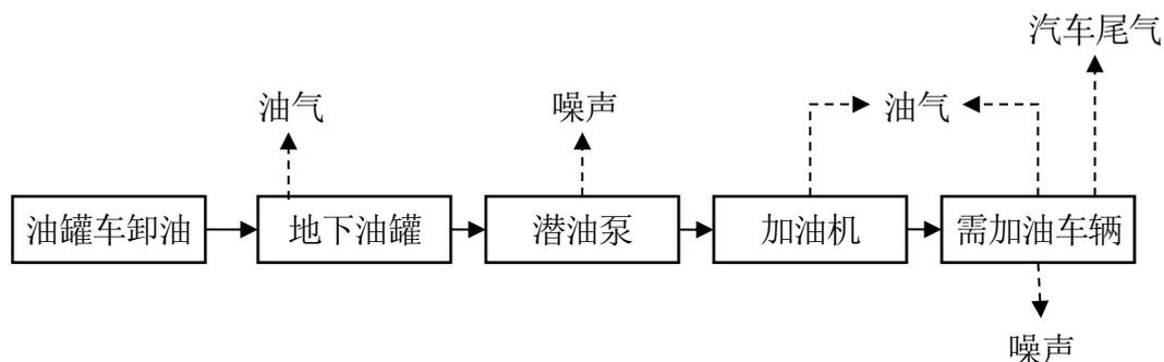
图 4 柴油加油工艺流程及产污环节示意图
