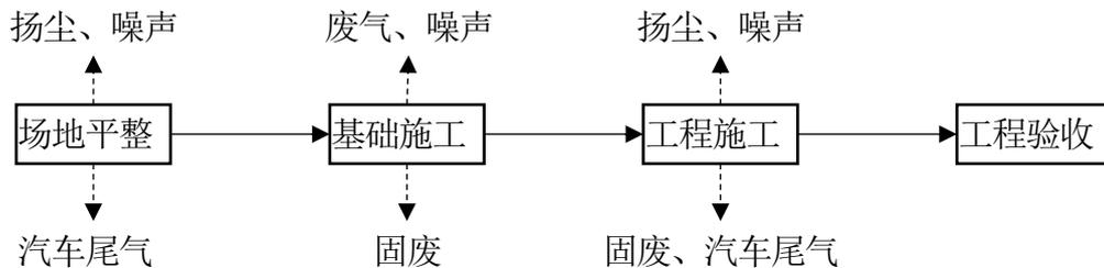
图2 施工期流程及产污节点示意图
