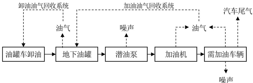
图3 汽油加油工艺流程及产污环节示意图
