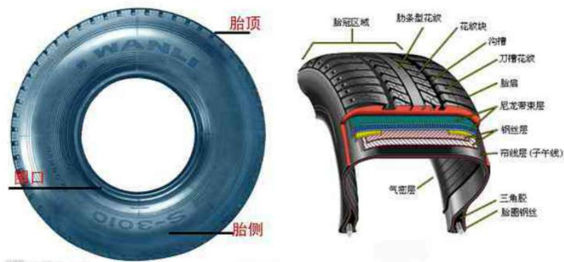
图 3.2-2 轮胎分解示意图
