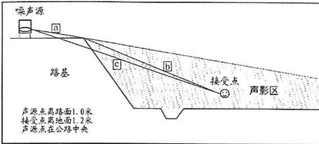
图9 声程差 $\delta$ 计算示意图
