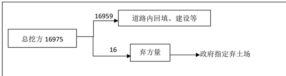
**图 3 项目土石方平衡图（单位：m<sup>3</sup>）**
