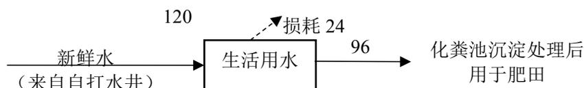
图 4 项目水平衡示意图 单位：m<sup>3</sup>/a
