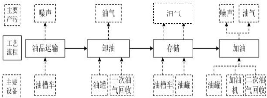
图 2 运营期卸油、加油工艺流程及产污位置框图
