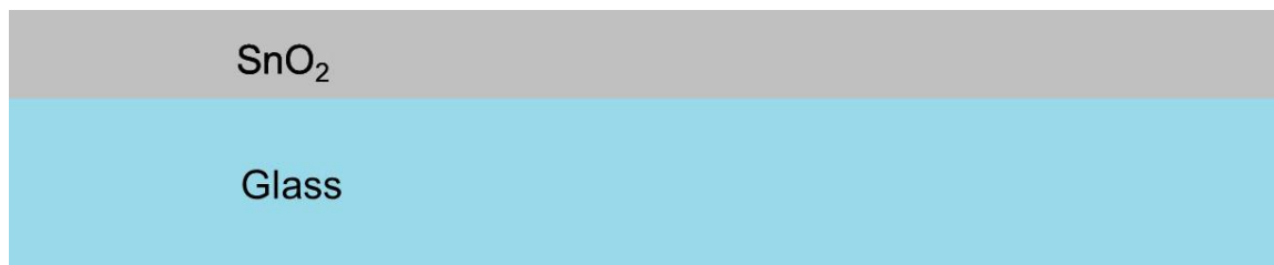
图3-2. 透明导电玻璃结构示意图
