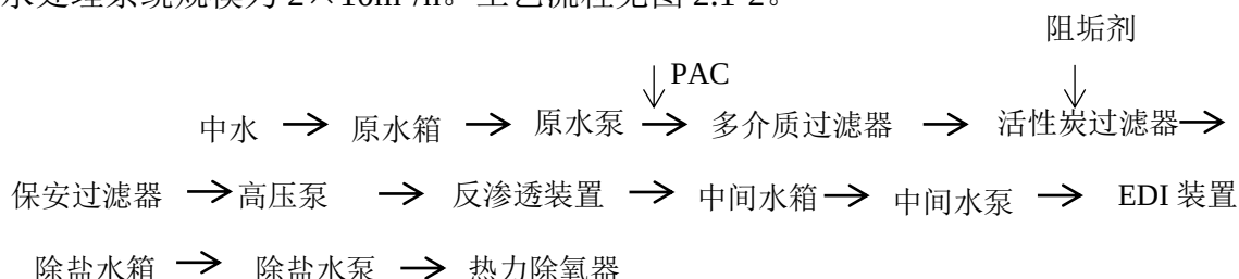
图 2.1-2 化学水制备工艺流程图
